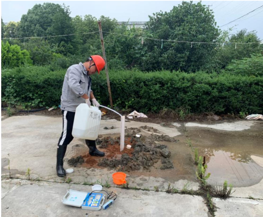
图 4.2-3 现场洗井照片
